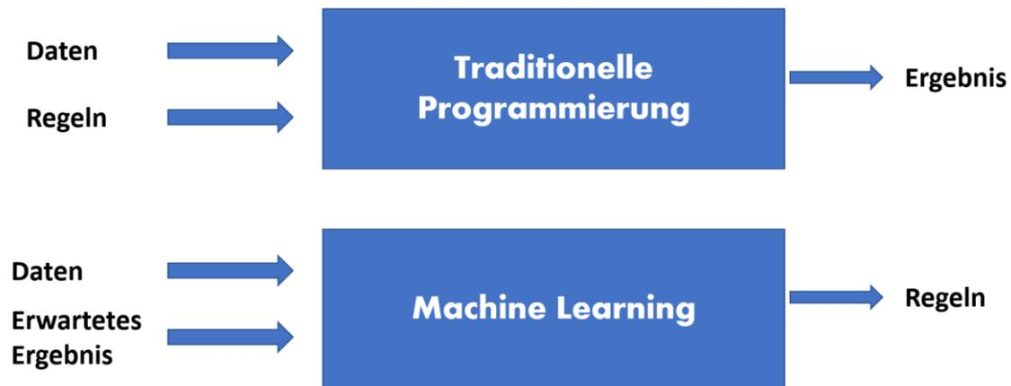
Abbildung 1 Der Unterschied zwischen Machine Learning und „klassischer“ Software (1)
