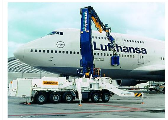
Abbildung 3: Das Flugzeugreinigungssystem „SKYWASH“, [FHG].
