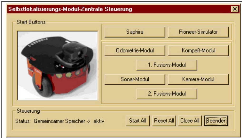
Abbildung 41: Die zentrale Steuerung des Selbstlokalisierungsmoduls.
