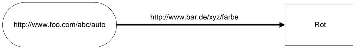
Abbildung 2.2: Beispiel eines RDF-Graphen
