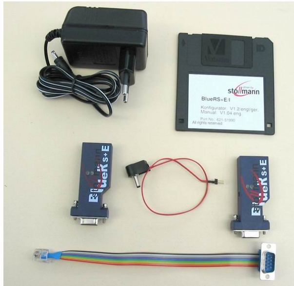
Abbildung 4.6: Bluetoothverbindung: Netzgerät, Paarungs-Software, 2 x Bluetooth-Adapter, SV-Kabel BT-AKSEN, Datenkabel BT-AKSEN
