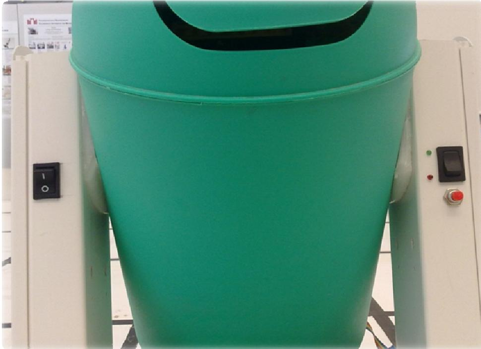
( **BILD 1:** Ansicht von hinten, Bedienelemente zur Inbetriebnahme sowie Umschaltfunktion zwischen dem Flash- (Rote LED) und Betriebsmodus (Grüne LED) des Aksen-Boards mit LED-Anzeige und inkl. des Flash-Tasters )
