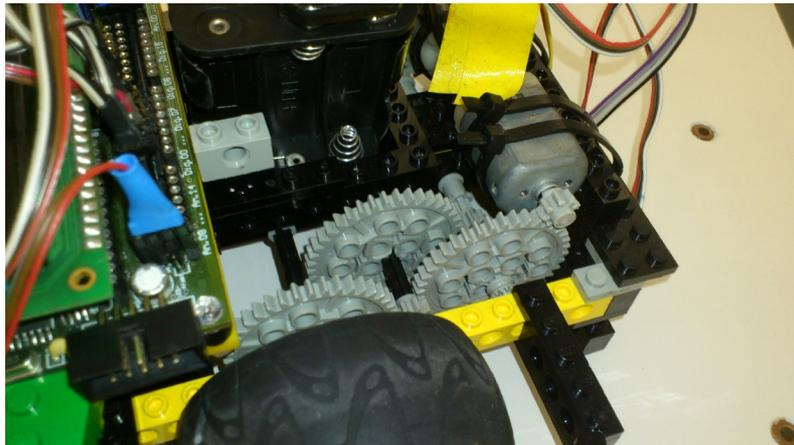
Abbildung 3: Das neue Getriebe mit Motor
