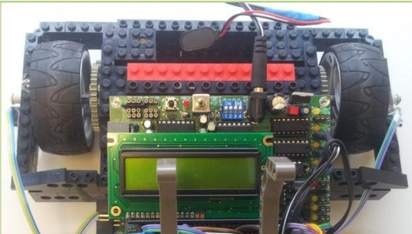
Hurby wurde durch einen Rahmen aus Legosteinen zusätzlich stabilisiert, damit die Radachsen nicht durchgebogen werden.
