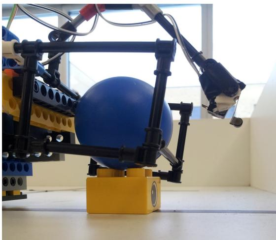
Im Bild links sieht man den Käfig zum aufnehmen des Balls und den Druckschalter zum ertasten einer Wand.
